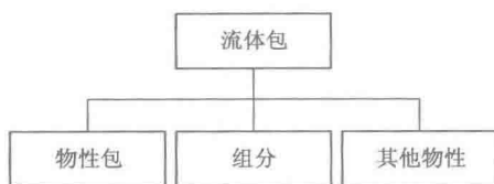
图 2-1 流体包的结构
