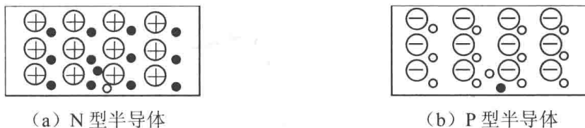
图 1-1 N 型半导体和 P 型半导体
