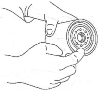
图 1-1-4 在密封部位涂抹干净的发动机机油
