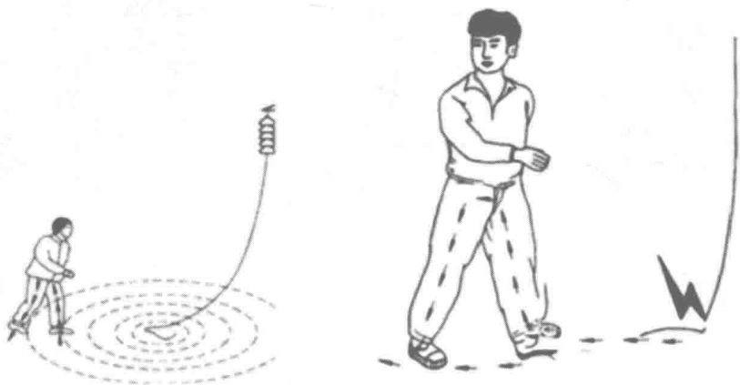
图 1-3 跨步电压触电
