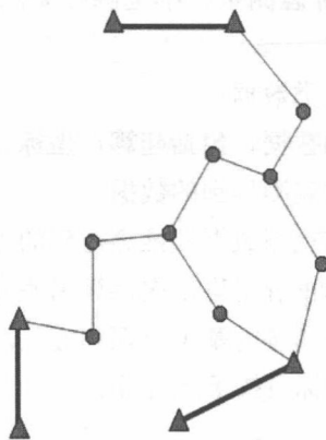
图 1-2 三个结点组成的导线网
