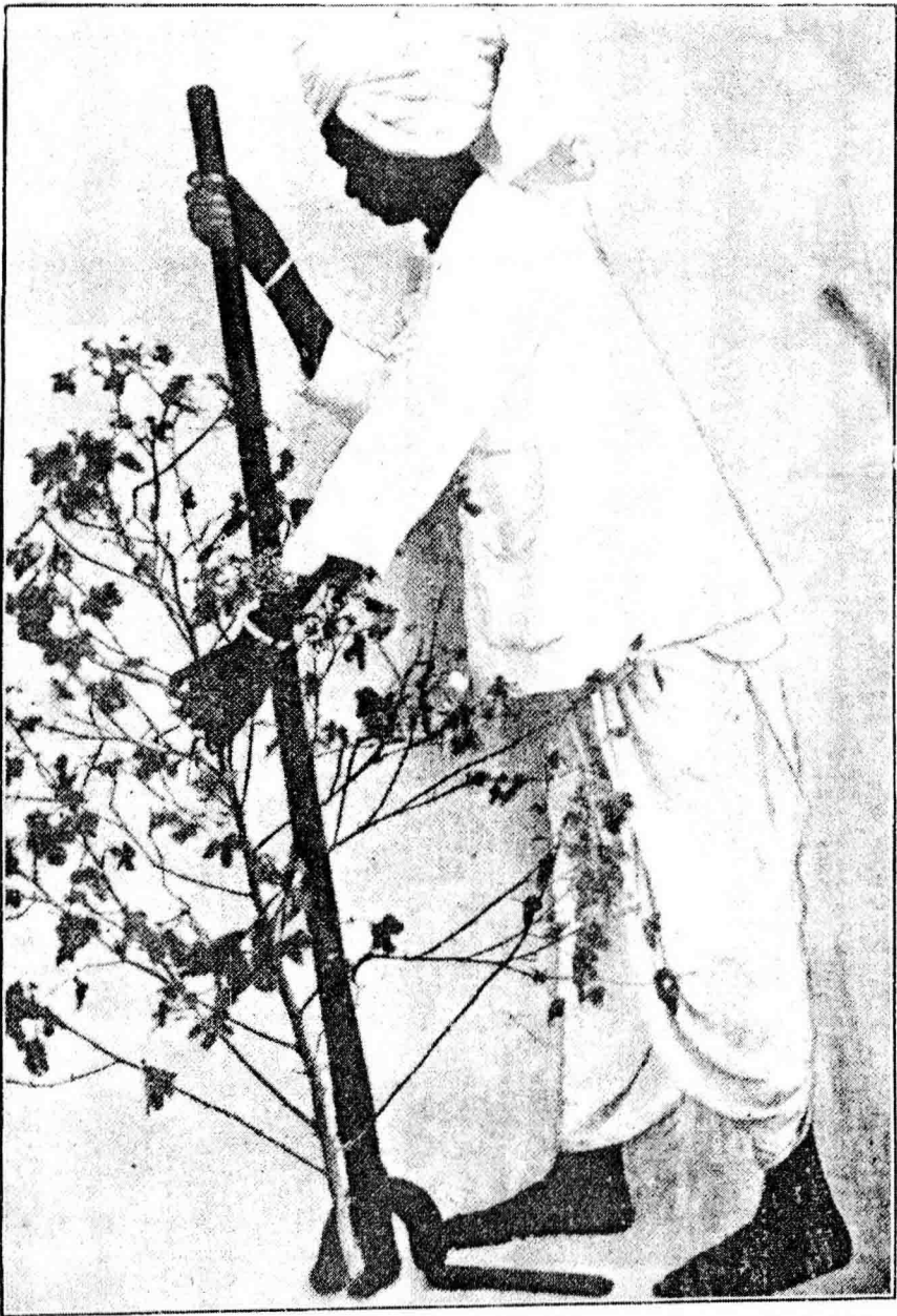
(一) 宣傳廣告之一 —— 圖示勸導棉農購用「棉株除根器」(Cotton plant puller) 此項工具係特製用以清除棉株之根與餓死紅鈴害虫 (按英文Pink Boll-Worm Pest of Cotton即紅鈴害虫——日名赤實虫——中國各地所產棉花均患此種虫害估計每年損失價值在六〇,〇〇〇,〇〇〇元以上)
