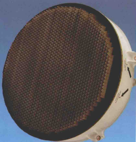
▼ 美国 AN/APG-81 有源相控阵火控雷达 天线阵面
