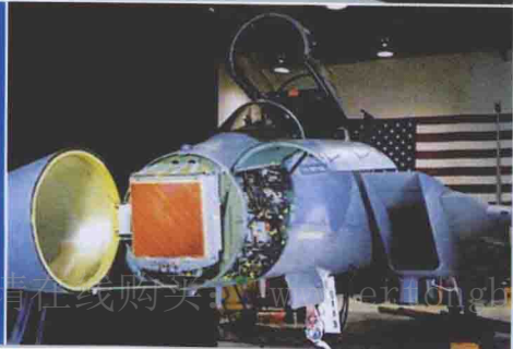
◀美国 AN/APG-63(V)2 相控阵雷达安装在 F-15C 飞机上
