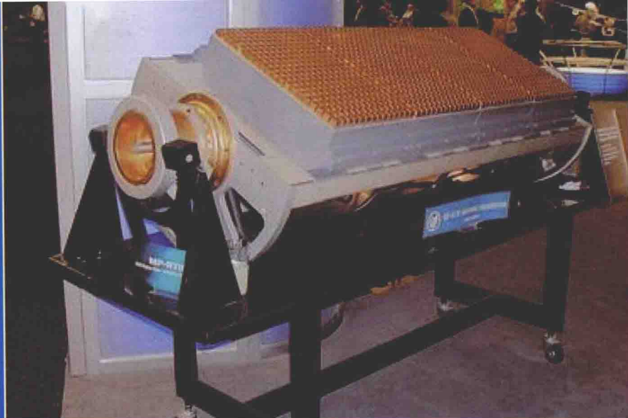
▶ 美国 MP-RTIP 动目标指示 / 合成 孔径雷达天线
