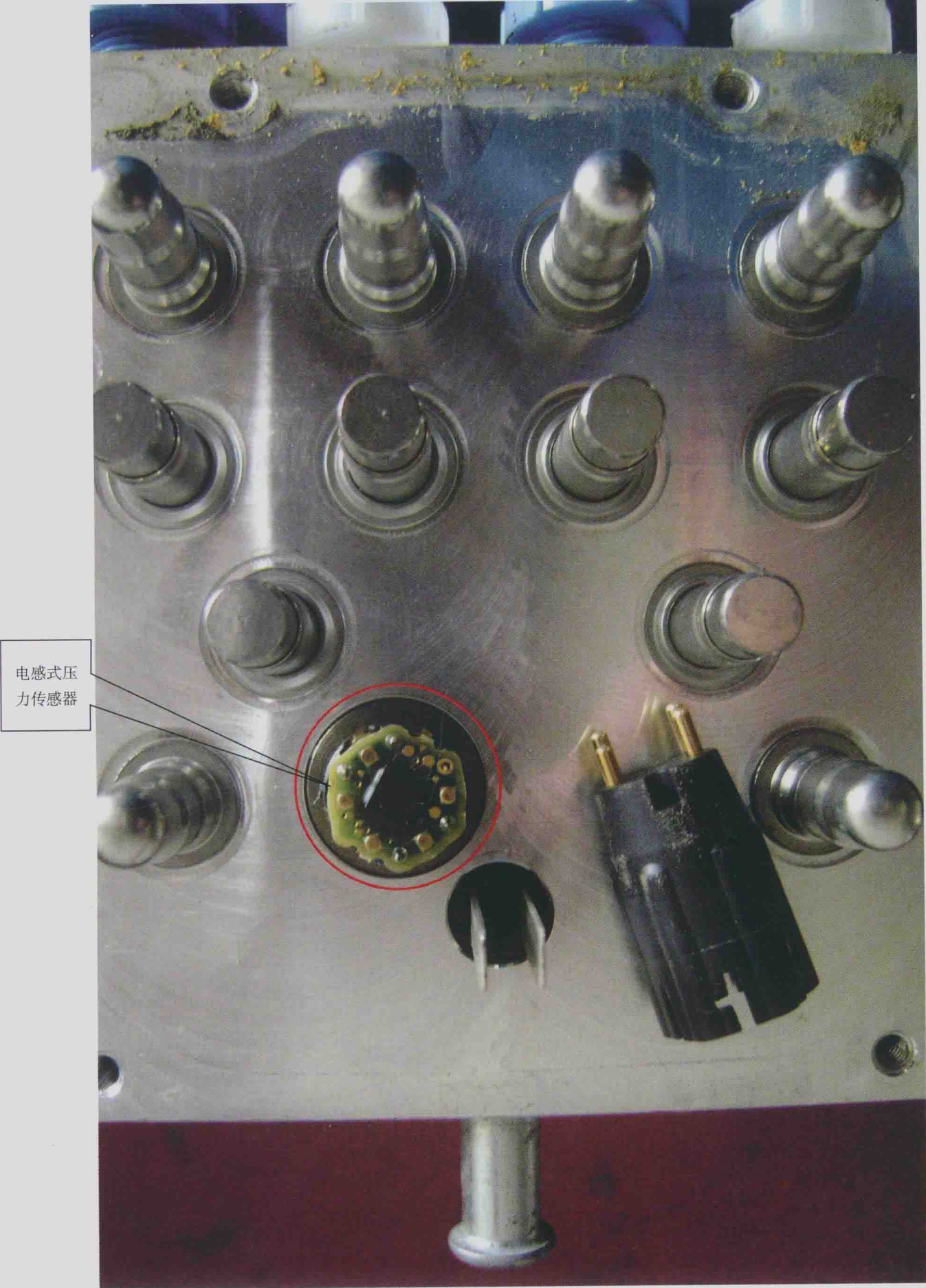
图 1-5 压力传感器作用和结构图
