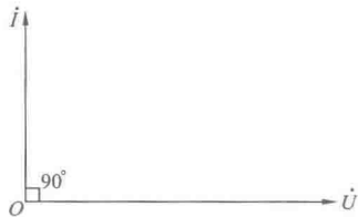
图 1-6 交流电容电路相量图
