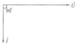
图 1-3 交流电感电路相量图
