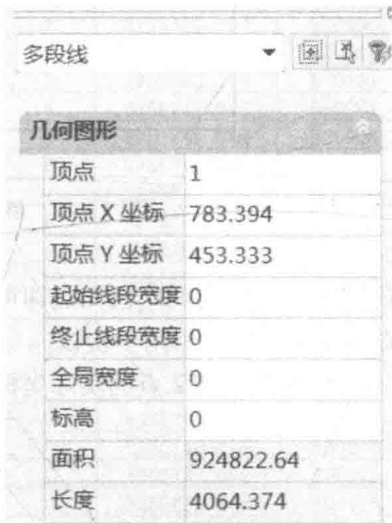
图 1-15 在特性窗口中查询多边形的面积和周长
