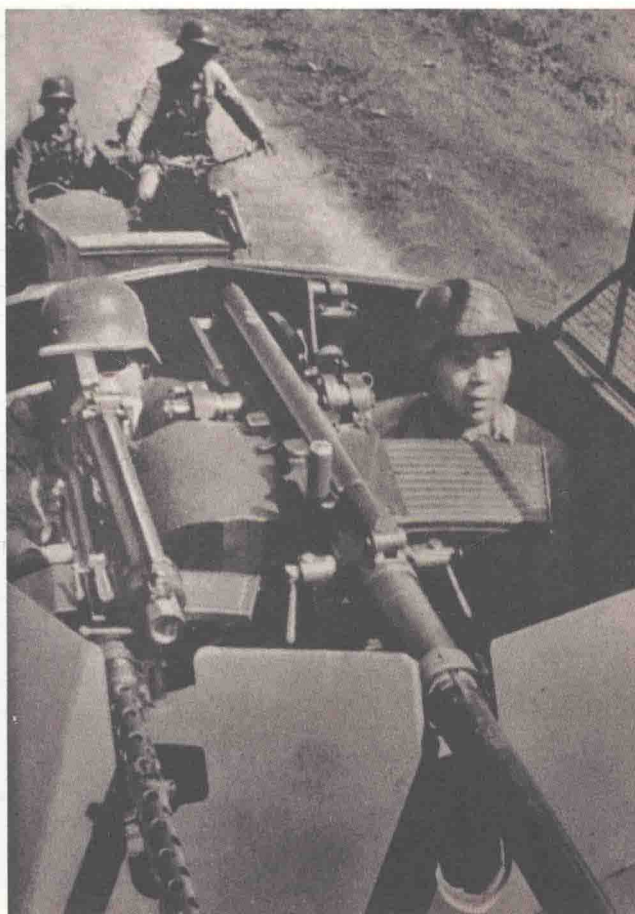
能使枪炮口提升到足够高度，以打击俯冲飞机的开放性炮塔：一辆奔赴前线的中国装甲车
