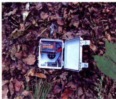
图 5-9 灭鼠无线电波装置
