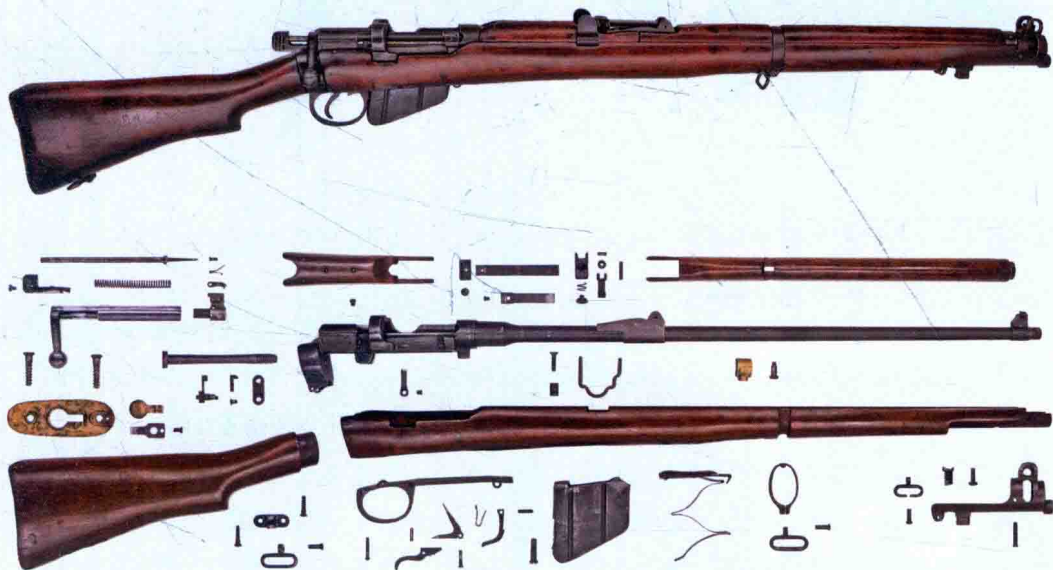
李-恩菲尔德步枪MK III型步枪及拆解图
