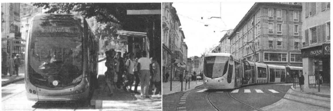
图 1-9 地面供电和吊挂电力网系统的现代有轨电车
