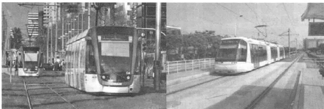
图 1-8 钢轮钢轨系统（左）和胶轮+导轨系统（右）的对比图
