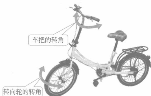
图1-2 自行车车把的转角与转向轮的转角相等
