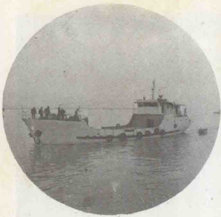
头船舶修造厂制造的175吨钢丝水泥货轮
