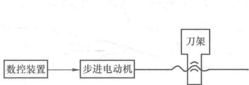
图 1-6 开环伺服控制系统框图
