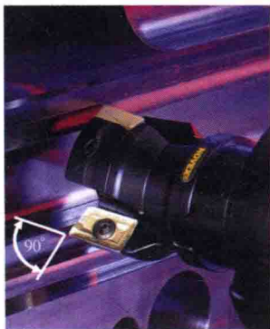
图 1-18 立铣刀的圆周刃和端面刃铣削
