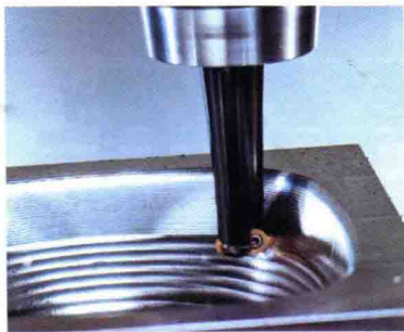
图 1-21 圆角铣刀的仿形铣削 (图片源自山特维克可乐满)
