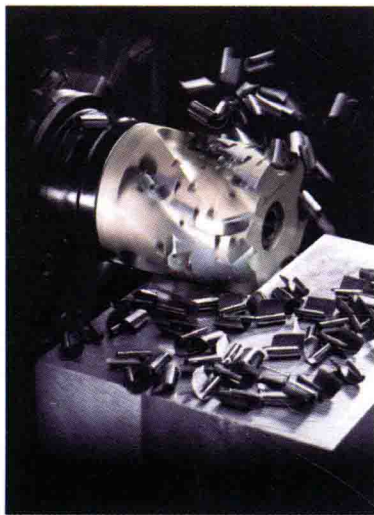
图 1-17 玉米铣刀的圆周铣削
