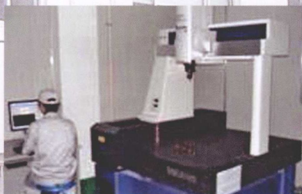
日本MITUTOYO精密数控三坐标测量仪 Japanese MITUTOYO 3D CMM
