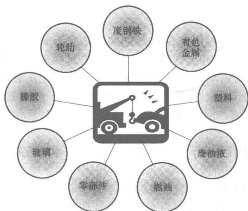
图 1-1 报废汽车拆解再生资源示意
