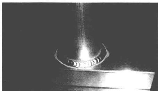
图 1-3 交流氩弧焊焊接铝合金焊缝
