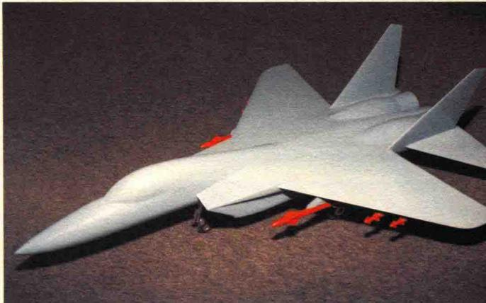
► 这一款设计型号最接近最终的米格 -29。该模型机第一次利用机身机翼融合设计，并加大机翼前缘延伸板和下部进气口的弯曲幅度。注意水平尾翼的后缘伸展板。
