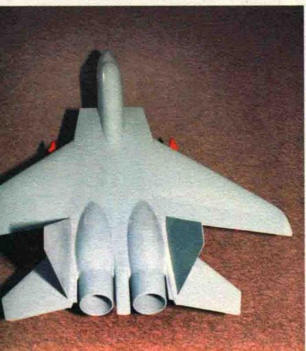
从后视角度看，该机型与 F-15 相比，机翼后缘伸展板更大，发动机之间的间隔也比较大，发动机之间安装了自动伞，这是美国飞机不具备的。注意发动机舱盖的后面部分是如何与前面平坦的机身融合在一起的。
