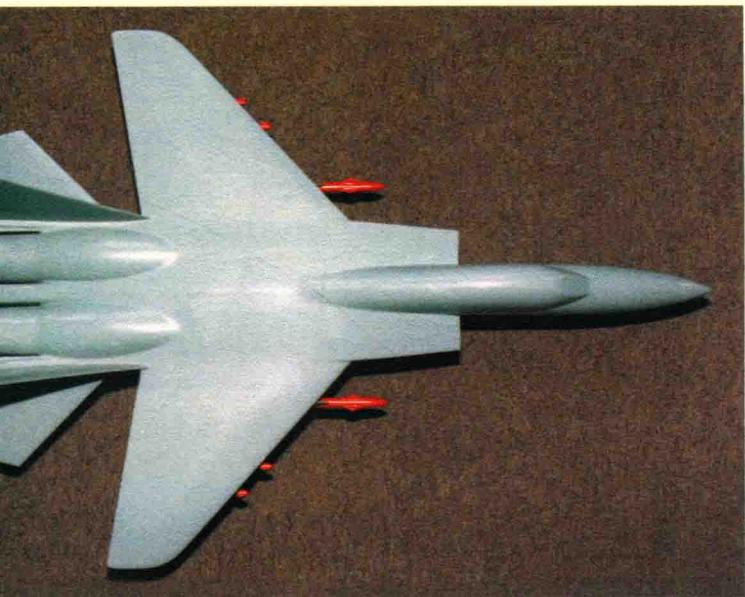
另外一架预备设计计划的米格 -29 型号。这架飞机也是按照传统理念设计的，看起来与 F-15 十分相似，机翼的形状和水平尾翼有些区别，而最大的区别在于双向外倾斜的垂尾，而 F-15 是双垂直尾翼。倾斜垂尾可以提高扭转阻力。
