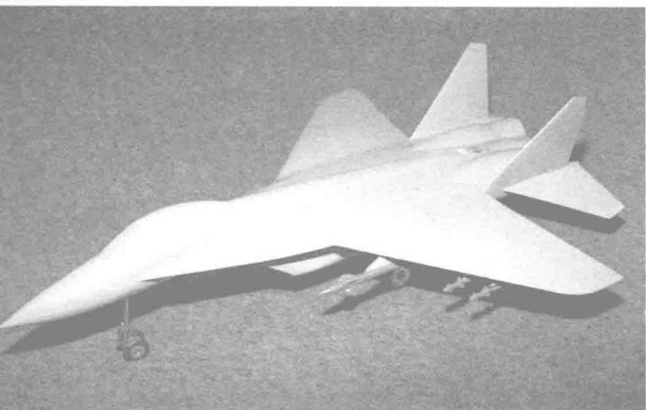
► 该图显示飞机起落架轴距和前起落架的拉杆过长（后来有所改进）。这一设计型号的各项比例指标与其竞争对手——苏霍伊的最初型号 T-10（苏 -27）非常相似。
