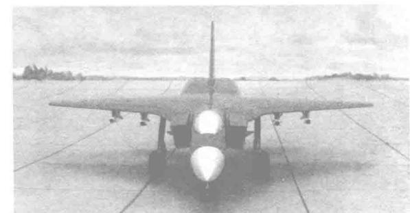
▲这副图清晰地显示了飞机的肩射机翼和小翼根前缘边条、泡型座舱罩、单垂尾翼和方向舵和短着陆悬挂轴距。前起落架可能向前收回。
