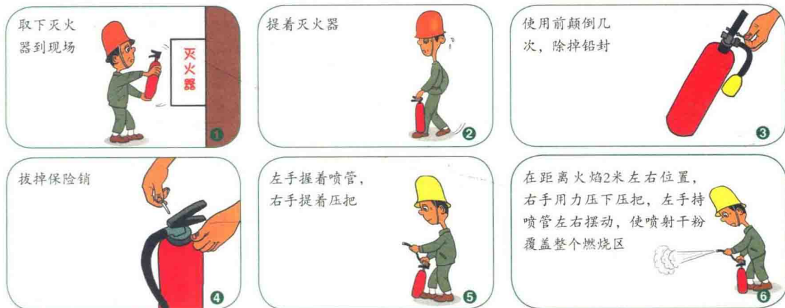
图1 手提式干粉灭火器使用方法
