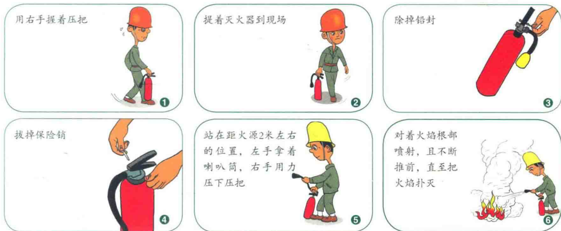
图4 二氧化碳灭火器使用方法
