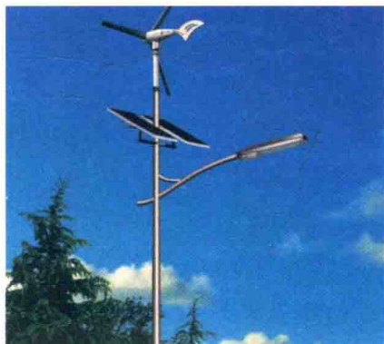
图4 利用太阳能和风能发电的风光互补型路灯
