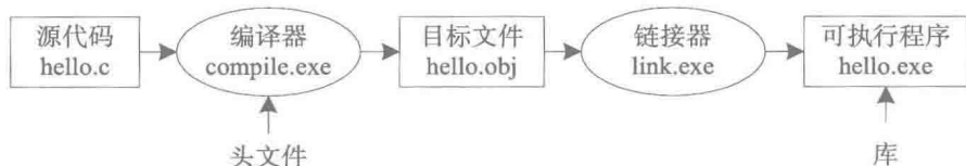
图 1-1 利用编译器和链接器为 C 程序产生一个可执行程序的过程
