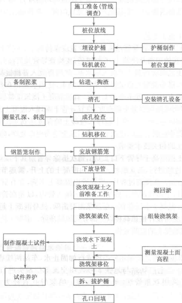
图 1.3-1 钻孔灌注桩施工工艺流程图
