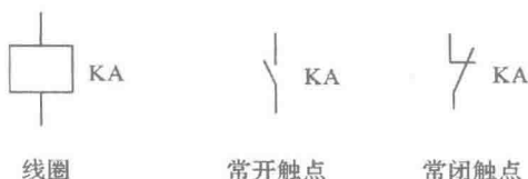
图 1-11 中间继电器的图形、文字符号
