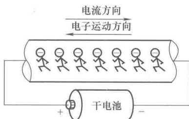
(b) 在电场力作用下导体中的自由电子定向移动 图 1-1 电流的形成
