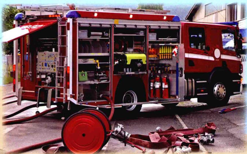
它的车厢里装满了救火用的器械（消防枪、水管、灭火器、水箱）和抢救伤员需要的工具（氧气面罩、急救包）。每一个活动绞盘上都有200米长的管子。
