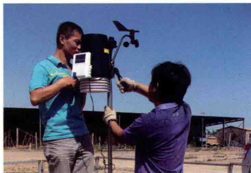
课题组成员在示范区安装气象设备
