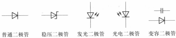
图 1.1.13 常用二极管的电路符号
