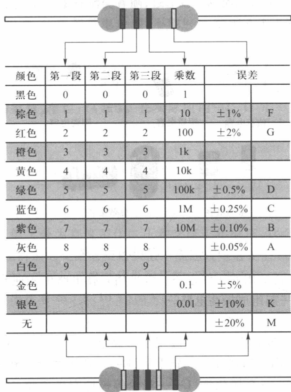
图 1.1.5 电阻的色环标注方式
