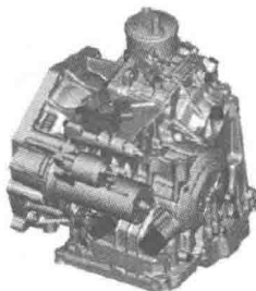
电液控制的六档行星齿轮自动变速器,最大扭矩达 250N·m
