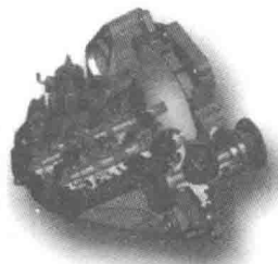
五档手动变速,最大扭矩 200N·m AQ200
