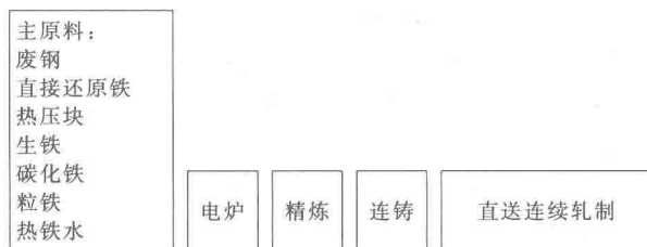
图 1-2 钢铁生产短流程工艺
