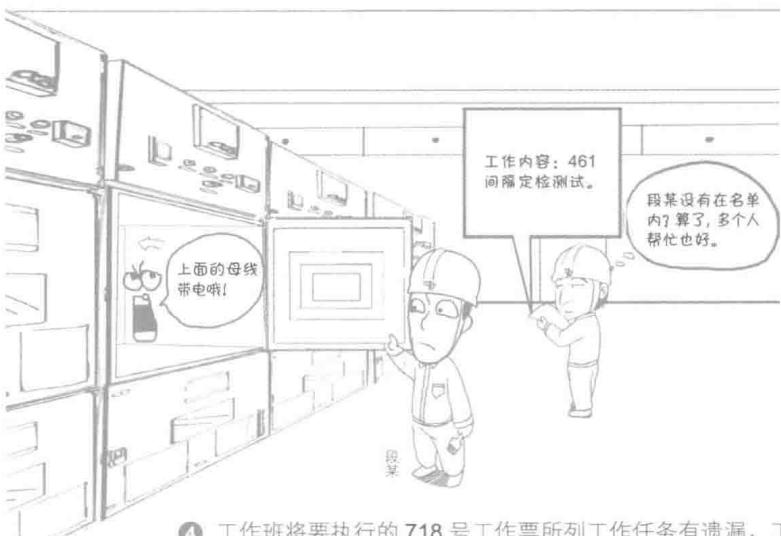
④ 工作班将要执行的 718 号工作票所列工作任务有遗漏，工作内容仅注明设备定检预试，未注明开关柜清扫工作。工作班作业人员段某不在工作票所列名单中，但仍参与开关柜清扫工作。
