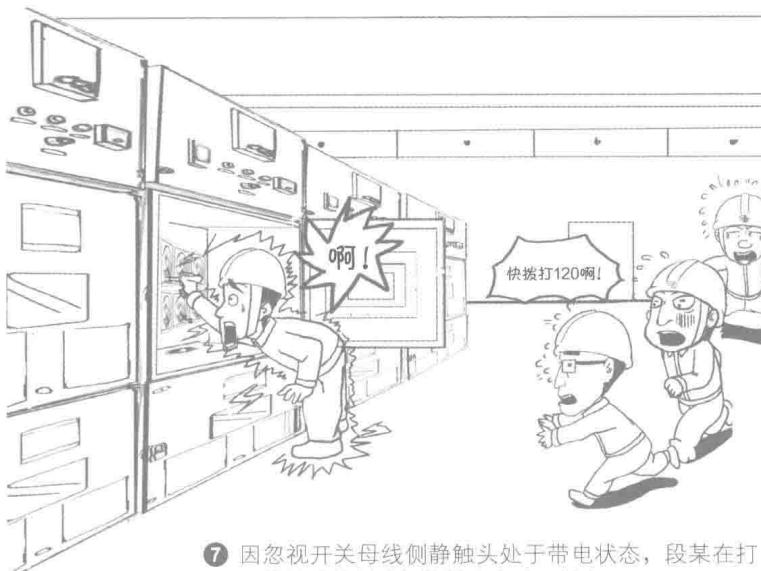
⑦ 因忽视开关母线侧静触头处于带电状态，段某在打开静触头挡板清扫静触头套时，触电死亡。
