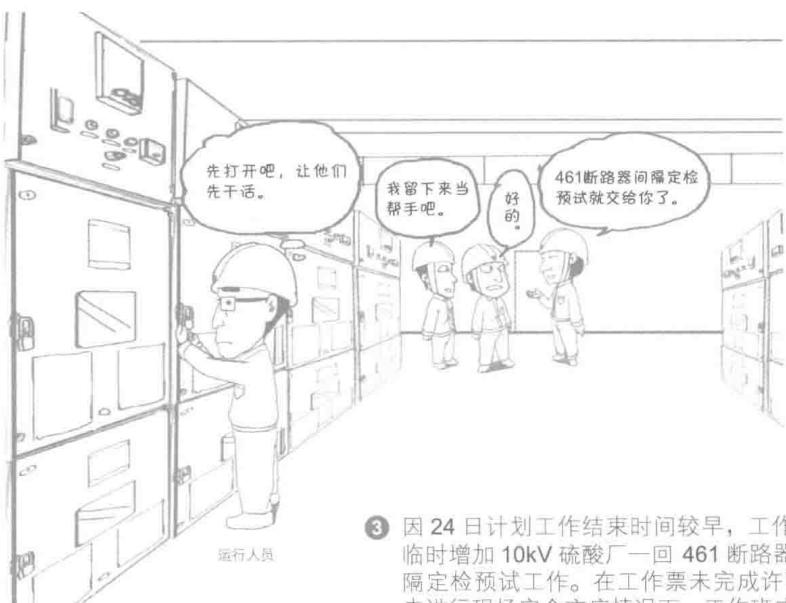
③ 因 24 日计划工作结束时间较早，工作班临时增加 10kV 硫酸厂一回 461 断路器间隔定检预试工作。在工作票未完成许可、未进行现场安全交底情况下，工作班成员用解锁钥匙打开 10kV 开关柜，将断路器拉开进行工作。
