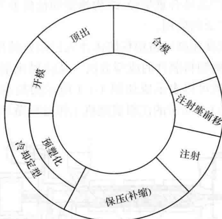
图 1-1-2 注射成型机工作过程循环周期图
