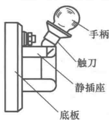
图 1-6 刀开关的典型结构
