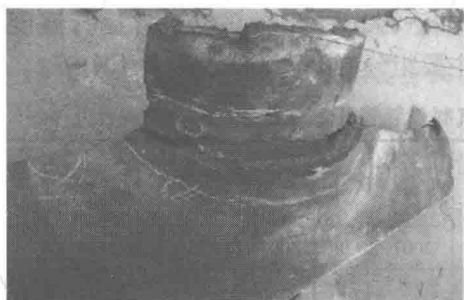
图 1-1-2 东侧焊口裂纹打开形貌
