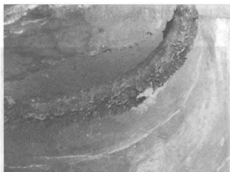
图 1-1-7 东侧焊口裂透部位宏观形貌
