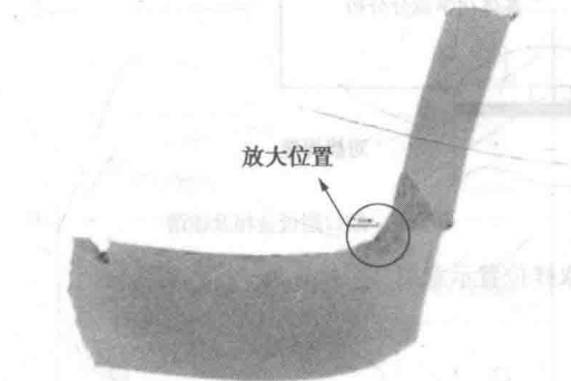
图 1-1-11 焊缝低倍宏观形貌
