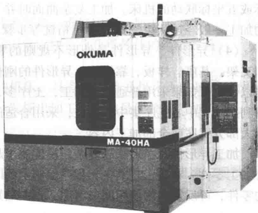
图 1-4 五面体加工中心
