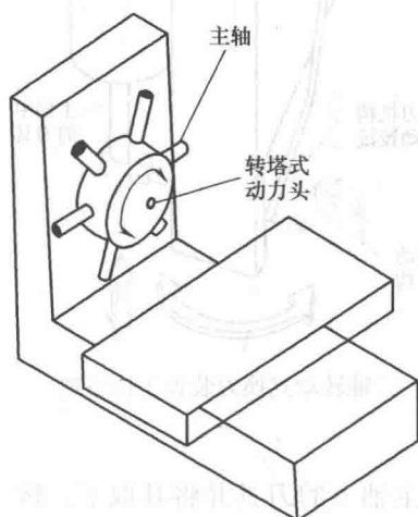
图 1-7 转塔式换刀装置示意图
