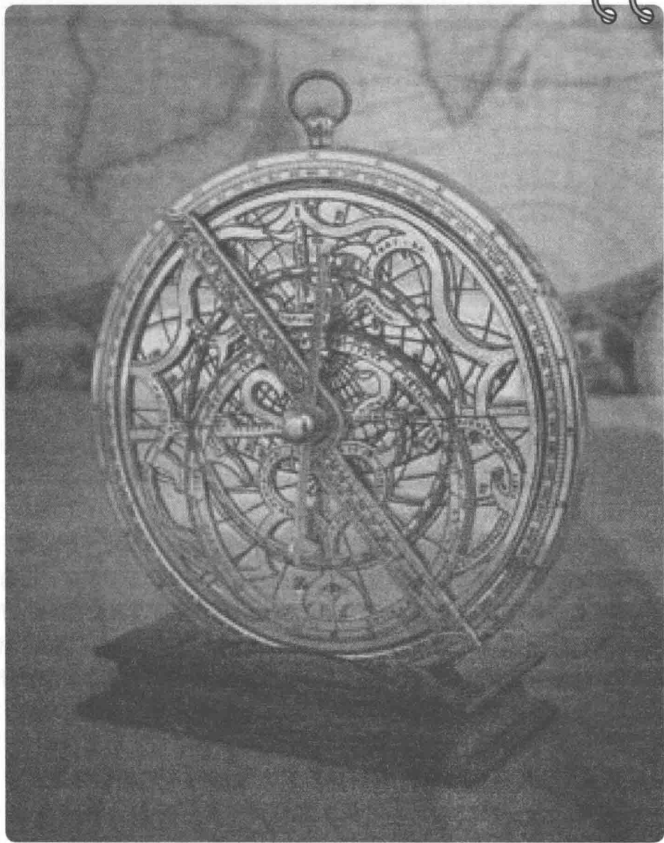
星盘可以帮助航海家们测量恒星的位置。在成百上千年的时间里，航海家们一直在航行的过程中使用星盘。(iStock)
